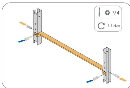
**Passo 2** Coloque o suporte de instalação no suporte FV. Ajuste o ângulo com ajuda de um nível e marque as posições para fazer furos. Faça os furos nas posições marcadas utilizando uma furadeira elétrica.
