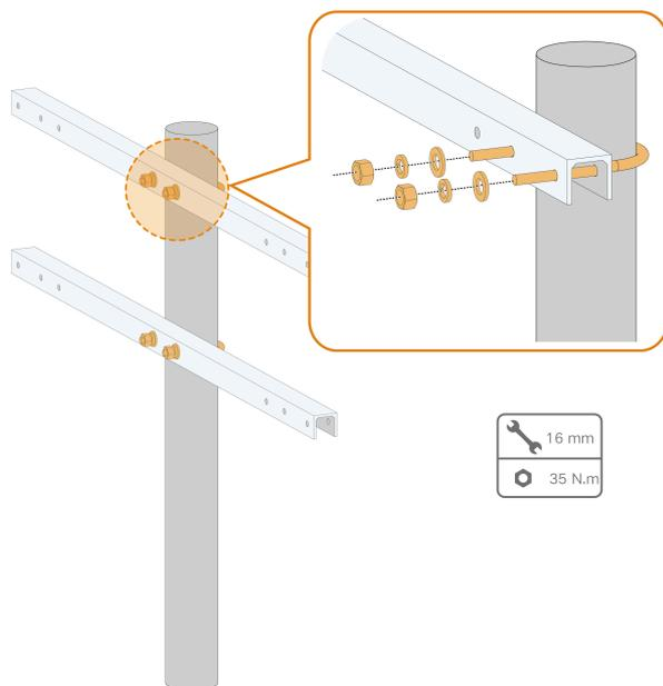
**Passo 5** Fixe o suporte de instalação nos perfis em U com parafusos.
