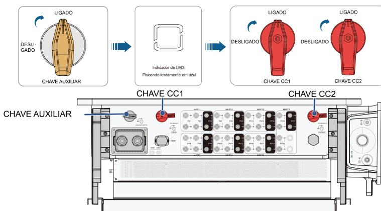
**Passo 3** Conecte as demais séries as entradas do inversor e coloque a CHAVE CC 1 e a CHAVE CC 2 na posição "ON" (Ligada).
