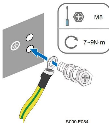
**Passo 3** Aplique tinta no terminal de aterramento para garantir resistência à corrosão.
