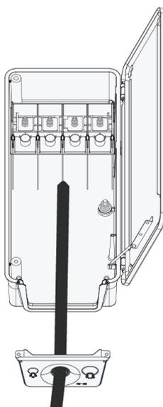
**Passo 6** Desencape a camada de proteção externa do cabo CA na parte interior da caixa de junção de acordo com a figura abaixo. Prenda os terminais OT/DT nos cabos desencapados. Fixe os fios aos terminais correspondentes (consulte a marcação de torque dentro da caixa de junção para obter informações sobre os torques de aperto). Organize os fios e recoloque a placa de vedação inferior.
