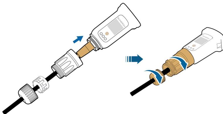
**Passo 6** Remova a tampa à prova d'água do terminal **COM3** e instale o WiNet-S2.
