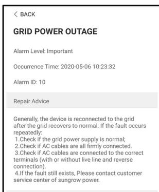
**Figura 7-9** Informações detalhadas do alarme de falha
