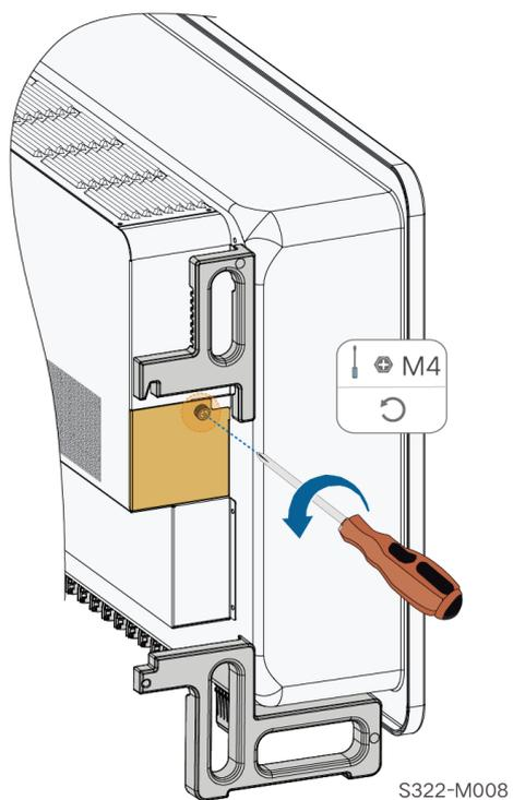
**Passo 3** Pressione a tecla no conector para liberar o elemento de travamento. Puxe o conector. Solte os parafusos no suporte do ventilador.
