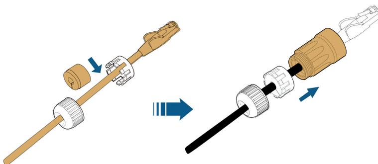
**Passo 5** Insira o plugue RJ45 no conector do plugue frontal até ouvir um clique e aperte o compartimento. Instale a gaxeta e aperte a porca giratória.
