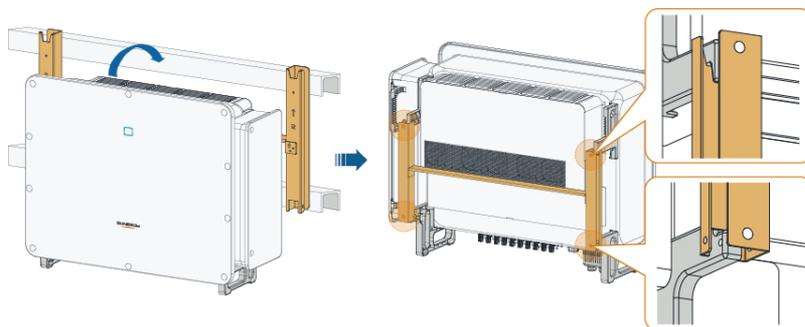
**Passo 3** Prenda o inversor no suporte de instalação com parafusos.
