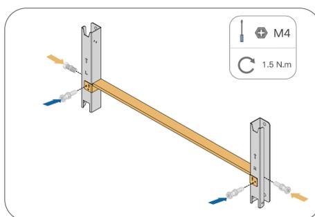
**Passo 2** Coloque o suporte de instalação na posição desejada. Ajuste o ângulo utilizando o nível e marque as posições para fazer os furos.
