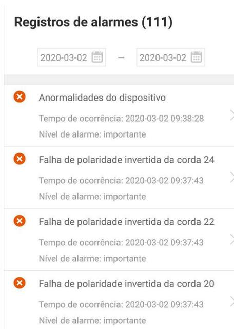
Figura 7-8 Registros de falha e de alarme
