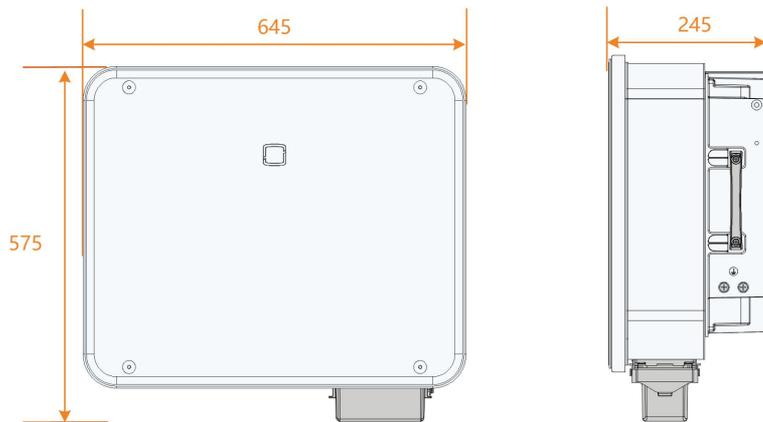
Figura 2-3 Dimensões do inversor (em mm)
