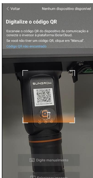
Figura 4 - Digitalização do QR Code do módulo de comunicação
