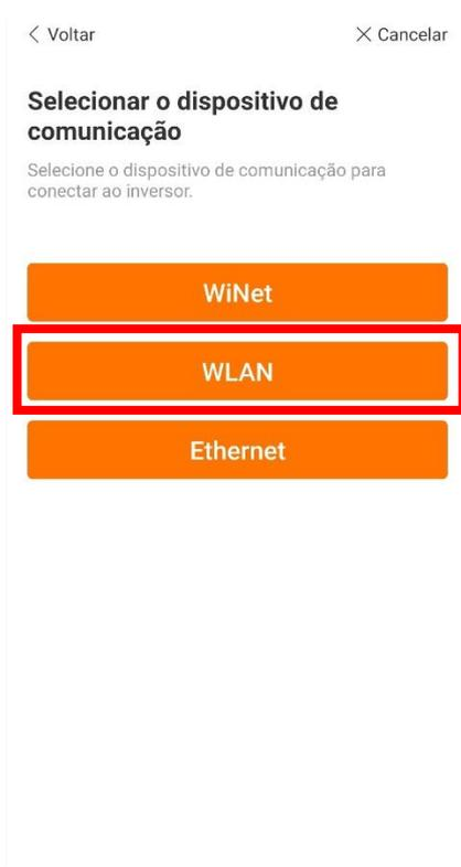
Após adicionado o dispositivo de comunicação, o aplicativo solicita a conexão junto ao WiFi gerado pelo próprio logger WIFI. Para fazer essa conexão, entre nas configurações de redes WiFi no seu celular e selecione a rede denominada SG-(Número de Série do Módulo WiFi):
