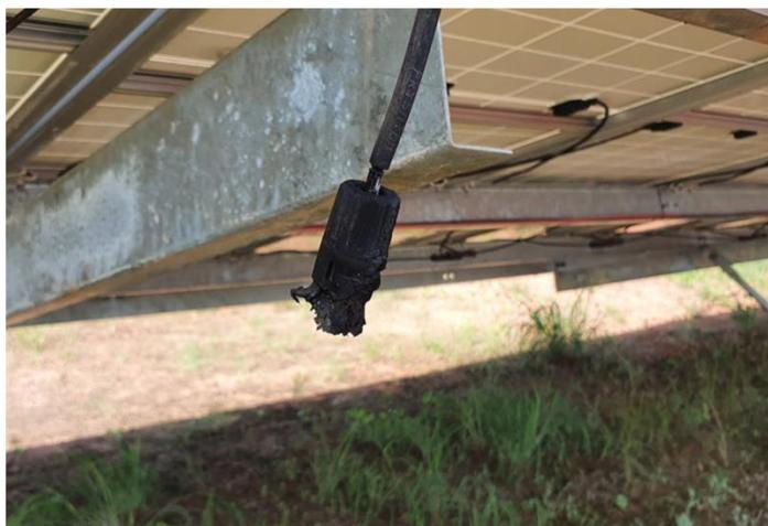
*Figura 4 - Conector CC danificado*
